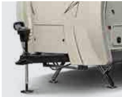
SYSTÈME DE MISE À NIVEAU ÉLECTRIQUE AUTOMATIQUE (BAL 5.3)
