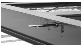
Fig. 1-Manivelle à travers le cadre Extension avec goupille
